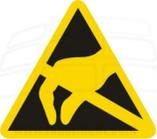
**EGB-Sicherheitshinweis:** Während der Wartungs- und Reparaturarbeit mit elektrostatisch gefährdeten Bauelementen an der Behandlungseinheit sind die allgemein gültigen **EGB-Richtlinien** im Umgang mit elektronischen Komponenten einzuhalten! Bei geöffnetem Gerät beachten Sie bitte die Vorsichtsmaßnahmen beim Umgang mit Platinen (EGB). Entladen Sie sich vor Berühren durch Anfassen eines Erdungspunktes (Stuhlbasis, Aufbaustange).
